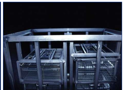
Einstellrahmen in Gitterboxgröße mit verschiedenen Körben
